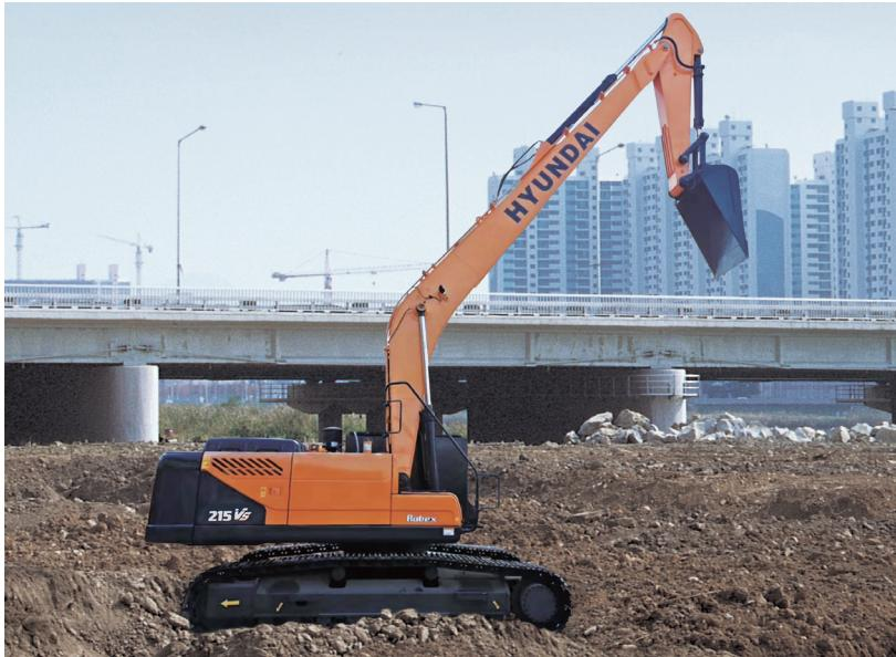
加长臂挖掘机，利用超长型动臂和超长型斗杆，可在疏浚、护岸、坡面以及地铁建设等受地面环境限制的工况下发挥作用。
