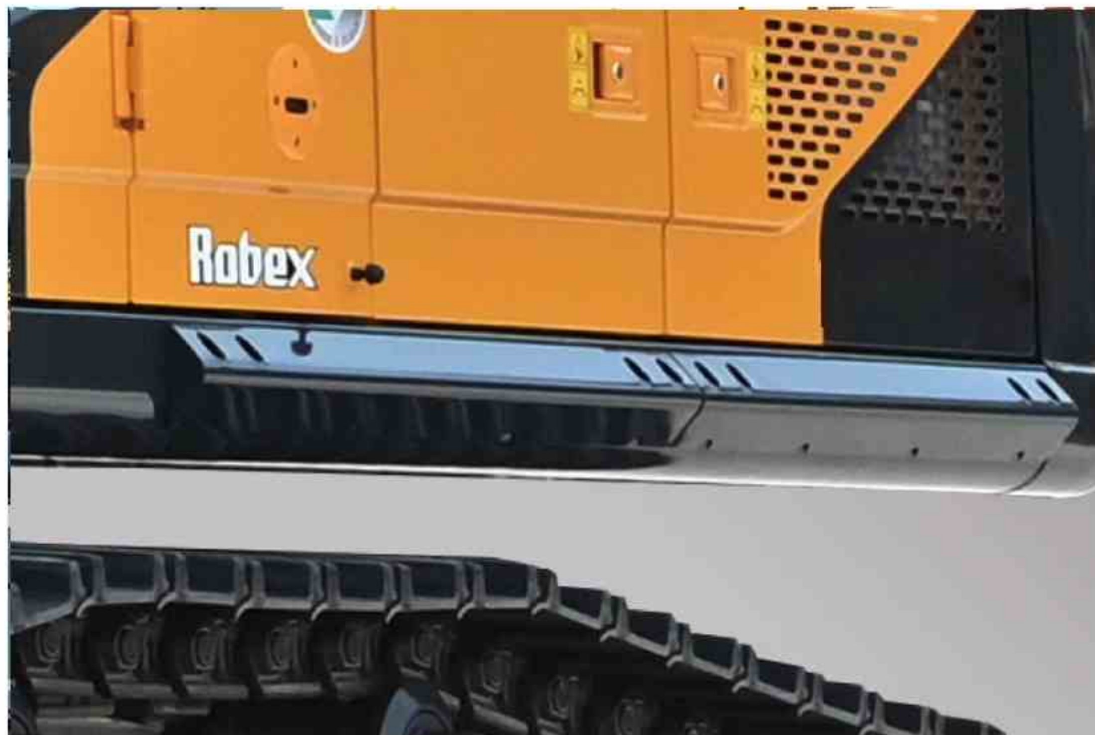
上部体两侧标配防护梁，提升上车结构的耐久性
