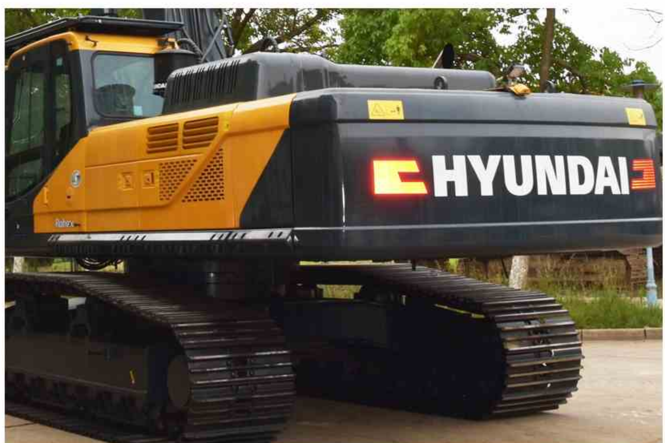
配重增加，整机打桩更稳定
