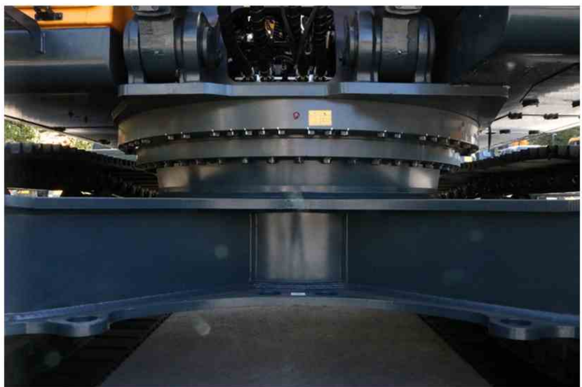
回转支承圈锻造一体式开发适用 应对更苛刻的环境
